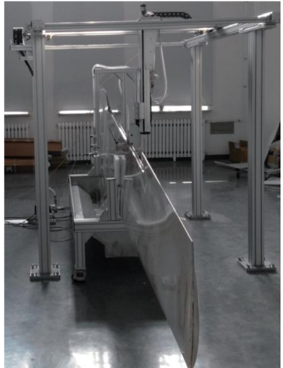
六轴（左3轴、右3轴）左右喷水 检测范围：长3000*高2000
