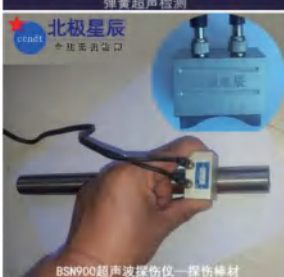
BSN900超声波探伤仪—探伤棒材
