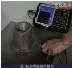
管-板角焊缝超声探伤
