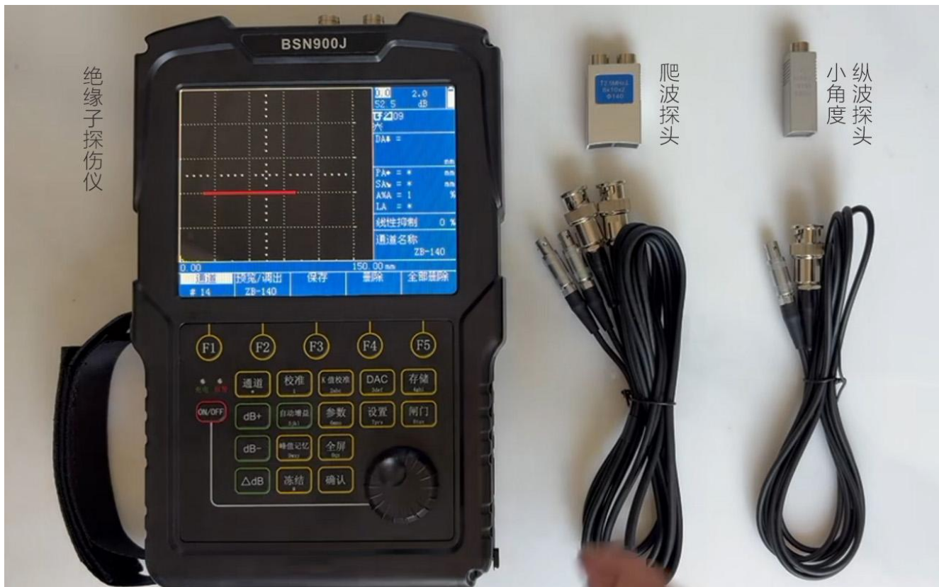
认识绝缘子探伤仪主机、爬波探头、小角度纵波探头
